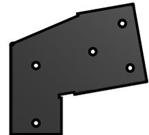
(1) - SOPORTE DE EXTENSIÓN DE LA VIGA DEL COLUMPIO - DERECHO - A4M00512
