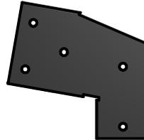
(1) - SOPORTE DE EXTENSIÓN DE LA VIGA DEL COLUMPIO - IZQUIERDA - A4M00511
